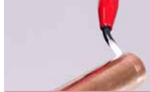
3. Käytä kynänmallista purseenpoistinta sisäreunoissa.
