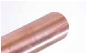
5. Tarkista, että putkessa ei ole vaurioita.
