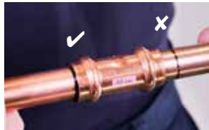
8. Työnnä putki kokonaan liittimeen. Varmista, että putki on työnnetty loppuun asti ennen puristusta.
