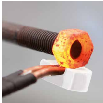
Ruostuneiden pulttien irrottaminen
